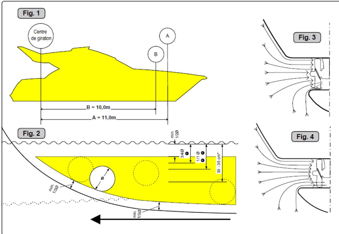
**Le propulseur devra être placé le plus possible à l'avant du bateau** (voir schéma n° 1)
