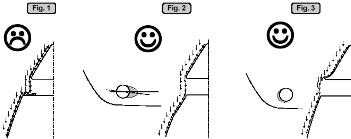
Sur les voiliers ou les vedettes rapides, il est possible d'être confronté au problème de traînées sur la face arrière du tunnel étant donné que cela provoque une surface plate face au flux de l'eau (voir schéma n° 1).
