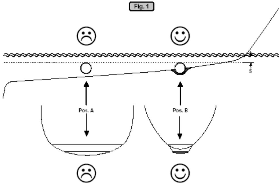
La plupart des voiliers ont une coque étudiée pour la compétition, ce qui signifie une étrave plate et peu profonde. Il est par conséquent très difficile, pour ne pas dire impossible, de monter un tunnel de propulseur normalement, en tout cas d'essayer de monter le propulseur le plus à l'avant possible de la coque (voir schéma n° 1).
