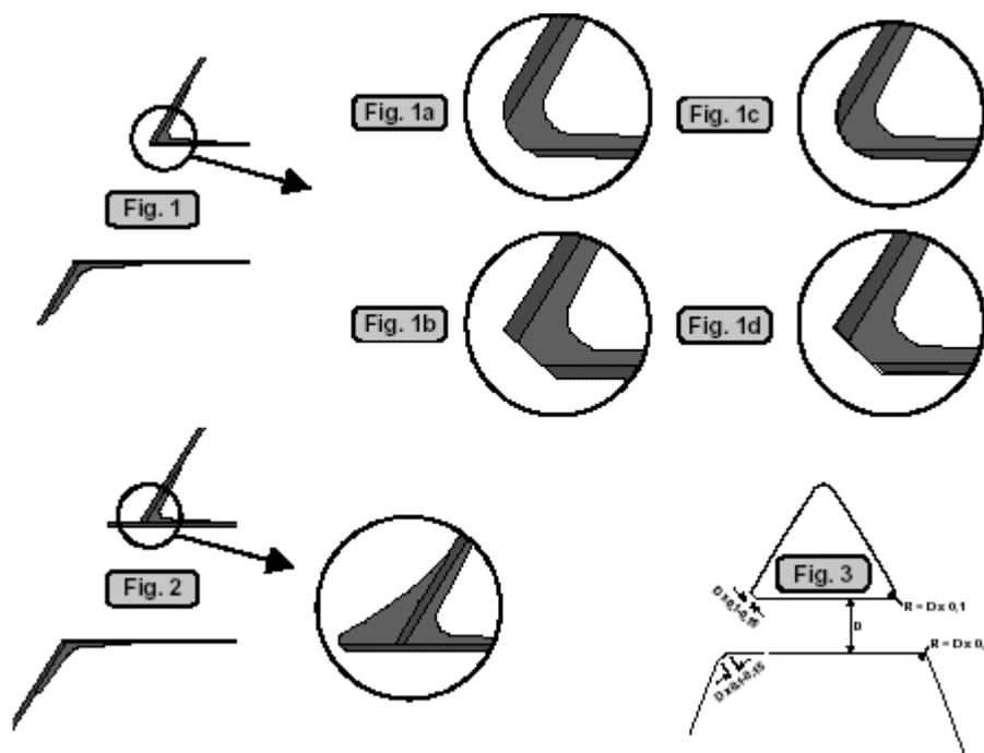
Réduire les angles à un rayon égal à 10 % du diamètre du tunnel (voir schéma n° 1a) ou faire un chanfrein dont la longueur représente 10 à 15 % du diamètre du tunnel (voir schéma n° 1c). Si ces deux méthodes ne sont pas réalisables, arrondir autant que possible l'extrémité du tunnel.
